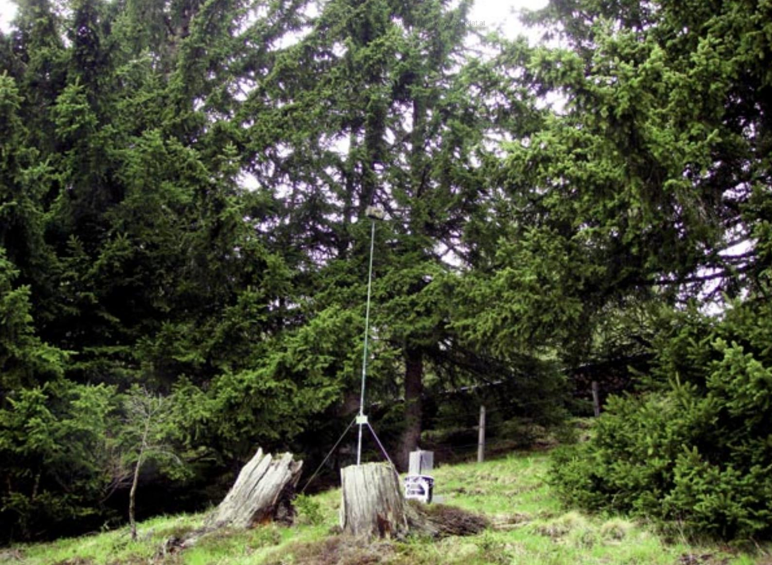
**Abb. 12:** Kombination von Lichtfalle und BATCORDER auf der Emberger Alm. Aufn. Ch. Wieser
