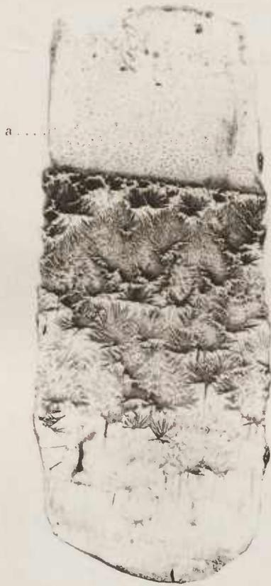
Galvanoplastischer Abdruck eines geätzten Glases.
