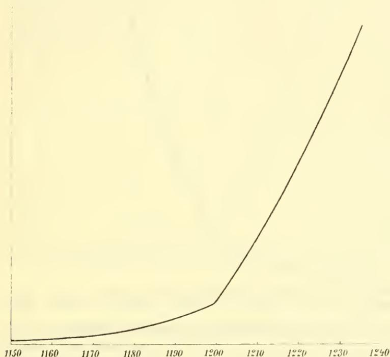
Fig. 9. Viskositätskurve des Augits von Arendal.
