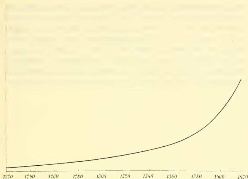
Fig. 5. Viskositätskurve des Anorthits.
