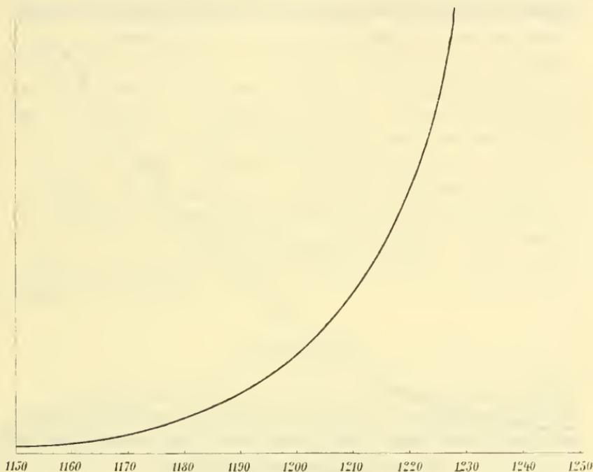
Fig. 2. Viskositätskurve des Albits.
