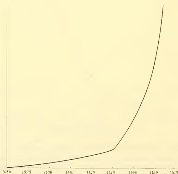
Fig. 8. Viskositätskurve des Hedenbergits.
