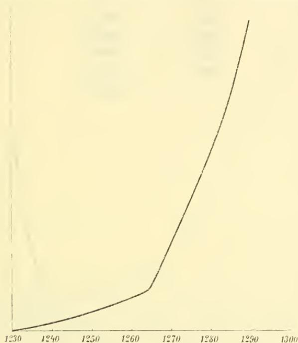
Fig. 7. Viskositätskurve des Diopsids.
