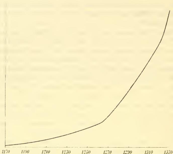
Fig. 4. Viskositätskurve des Eläoliths.
