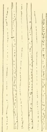
Fig. 2 Oxydulniederschläge in den Membranen von Rotholztracheiden der Fichte. Das Holz war vor Ausführung der Reaktion stundenlang in gewechseltem Wasser ausgekocht worden.
