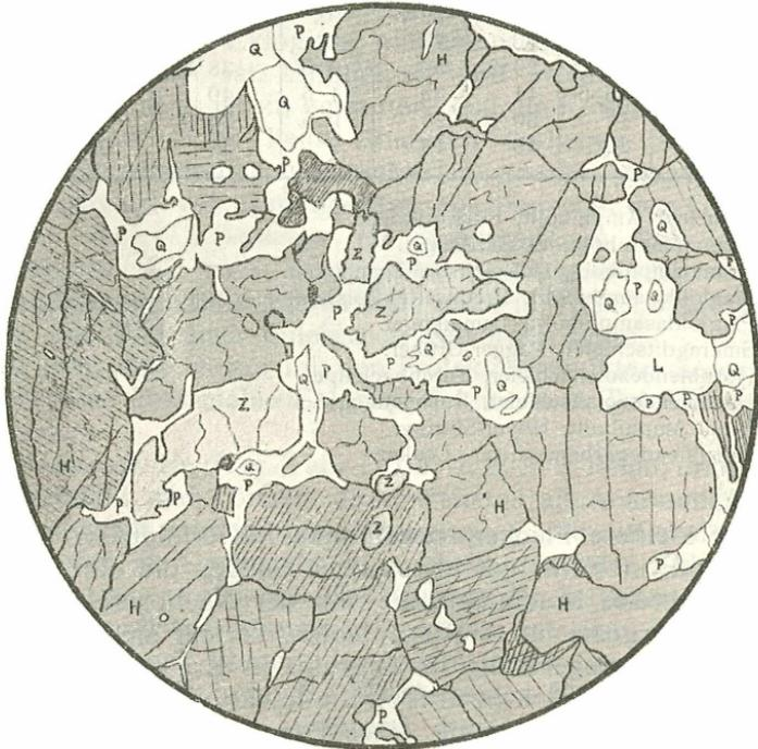
Fig. Dünnschliffbild (S 185) aus einem Eklogitamphibolit vom Gradisch bei St. Vinzenz, leicht injiziert. Der Kreis entspricht einem wirklichen Durchmesser von 5·5 mm. H = Hornblende, Z = Zoisit, P = Plagioklas, Q = Quarz, L = Loch im Schliff.
