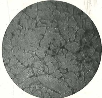
6. Messing mit 6.13% Sn nach d. Elektrolyse von 5. Anodenende.
