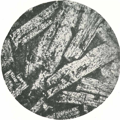
Fig. 3. Reiner synthetischer \alpha -Celsian. (|| Nic., 29fache lin. Vergr.)
