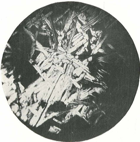
Fig. 4. Mischkrystalle { 80 Molprozent \alpha -Celsian, 20 Or. (+ Nic., 31fache lin. Vergr.)
