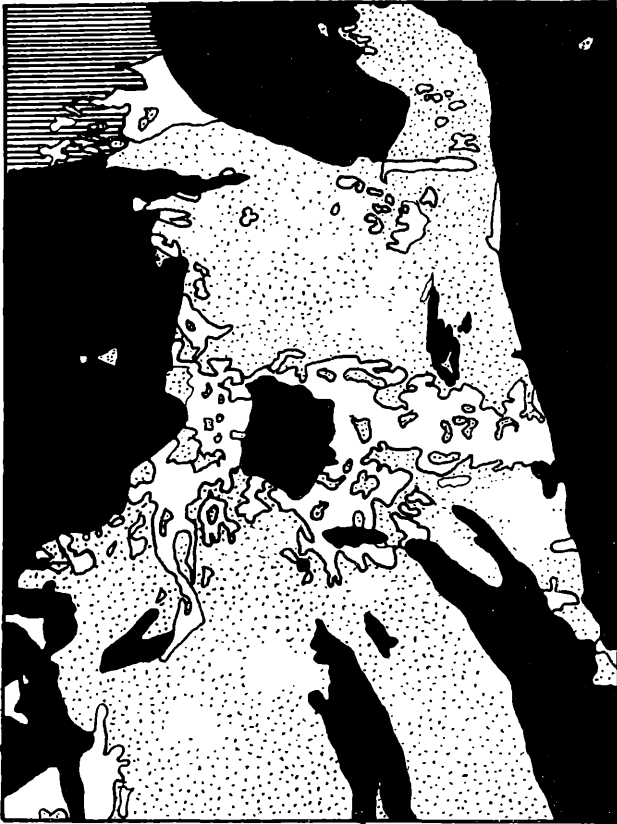
Fig. 2. Anschliff. 70 1. Wismutreiches Nest in Wismutglanz. Zeichen wie in Fig. 1.
