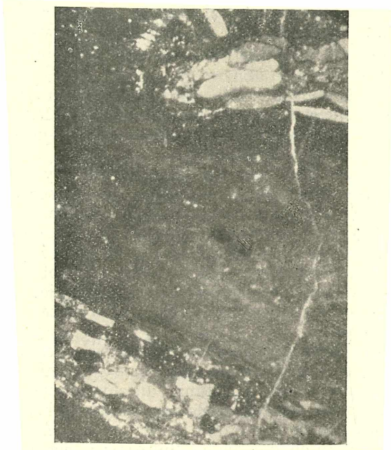
Fig. 2. Vergr. 180 \times . Dunkelfeld, Ölimm. Harz von Neusattel bei Elbogen. Verkiente lignitische Holzreste in einer gleichmäßigen (leuchtenden) Grundmasse.
