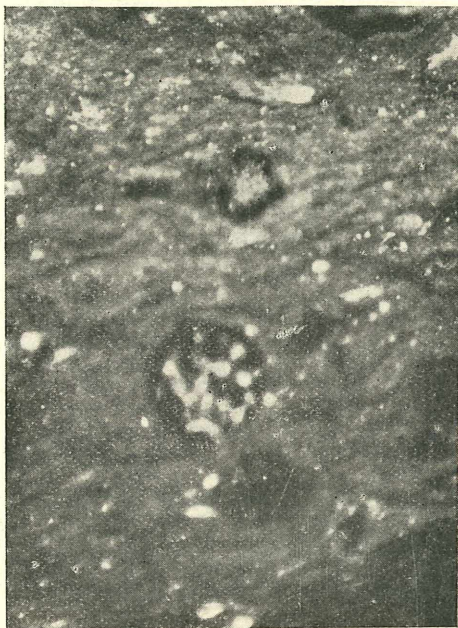
Fig. 3. Vergr. 180\times . Ölimm. Dunkelfeld, Cannelbraunkohle Bogheadschaft bei Falkenau. Harzkörner mit verschieden großen Bläschen und feine lignitische Fasern in der Grundmasse.
