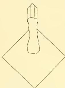
Fläche  $E$  (Fig. 3) der Glastafel ist dazu bestimmt, um auf ein Blatt weisses Papier  $FG$  aufgeklebt zu werden. Wachs klebt nicht immer sogleich, oder fest genug am Glase oder Papier; man wendet mit Vortheil eine ganz kleine Menge Canadabalsam an, den man erst, etwa stecknadelkopfgross, zwischen das Wachs und den Gegenstand bringt. Es ist sehr leicht der
