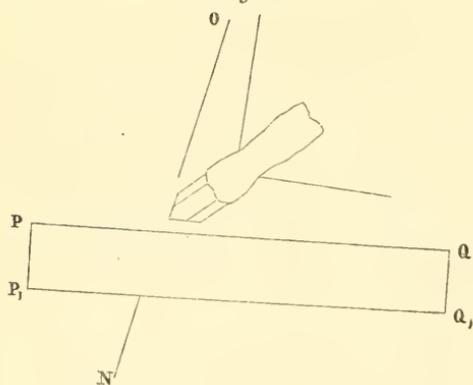
5. Der gleiche Vorgang unter der Loupe wird in Fig. 6 auf die zweite Fläche angewendet. Bereits ist nun die Linie NO auf dem Papiere gewonnen. Parallel der zweiten Krystallfläche wird dem Lineale folgend eine neue Linie gezogen.
