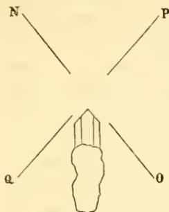
Linien  $NO$  und  $PQ$  auf demselben übrig, die man entweder selbst, oder andere denselben genau parallel liegende Linien zum Durchschnitte bringen kann. Am besten zieht man sogleich die den zur Orientirung dienenden  $NO$  und  $PQ$  parallelen Linien  $N'O'$  und  $P'Q'$ . Die Neigung der Linien gegen einander wird mittelst eines Transporteurs gemessen. Ist dieser genau und feingetheilt, nicht gar zu klein, und bedient man
