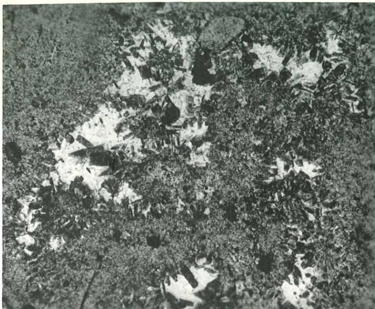
Abb. 1: Violettbrauner, mikrogranitischer Quarzporphyr (Gerölle) von Laßnitzhöhe bei G<sub>1</sub> (GRIESSL 54). Grobgranophyr: Hell = Quarz, darin dunkel = Feldspatkriställchen, grau = mikrogranitische Grundmasse. Vergr. = 60fach.
