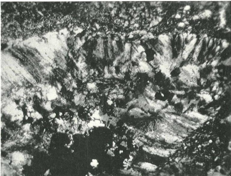
Abb. 4: Schwarzbrauner, mikrogranitischer Quarzporphyr (Gerölle) von Laßnitzhöhe bei Graz (GRIESSL 12). Felsitkörper in mikrogranitischer Grundmasse, Beachte den wandständig-faserigen Bau. Vergr.=48fach.
