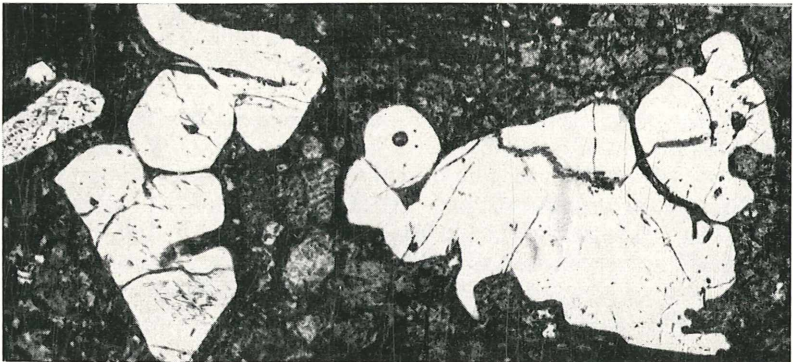
Abb. 2: Massiger Porphyroid (Gerölle) von der Platte-Graz. — Zwei besonders bizarre Formen von korrodierten Einsprenglingsquarzen. Korrosionsquarz rechts: 1 = 3,8 mm.
