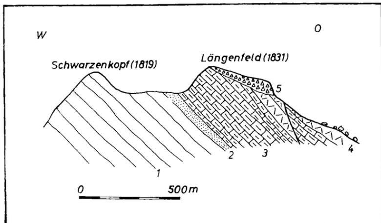
Abb. 2. Profil durch die Längenfeldbrekzie. Die heute völlig isolierte Lage als Erosionsrelikt wird deutlich. Die schuttliefernden Hinterhänge sind abgetragen. 1 = Wettersteinkalk, 2 = Raibler Sandstein, 3 = Raibler Kalk, 4 = Raibler Rauchwacken, 5 = Längenfeldbrekzie.
