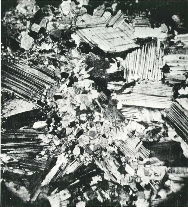
Abb. 1. Massiger Hornblendegabbro (Gerölle), TAGGER, Hönigthal. — Charakteristisches Gefügebild mit Labradoriten und feinkörniger Hornblende-pseudomorphose nach Pyroxen in der Bildmitte. Nic. + Vergr. 23fach.
