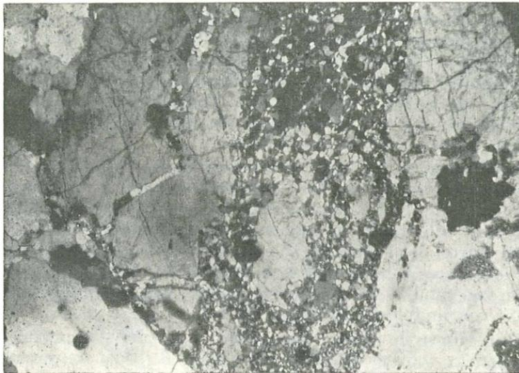
Abb. 5. Granittypus A/a (Nicols  $\perp$ ). Mörtelquarze als Kluffüllung in Kalifeldspathoporphorblasten.
