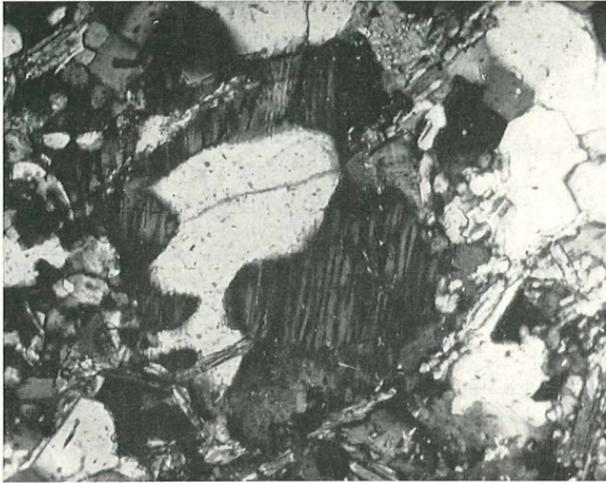
Abb. 1. Gneisaplit (Gerölle) von Krieglach. — Im Spindelperthit ( $\varnothing = 0,4\text{mm}$ ) ein „Korrosionsquarz“, gestaltlich ähnlich einem Porphyrquarz, diesfalls aber entstanden durch Metasomatose bei der Perthitkristallisation. Nic. +
