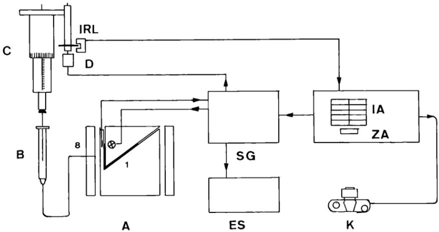
Abb. 2: Funktionsschema. Abkürzungen: A = Manometerblock, B = Mikroliterspritze, C = Mikrometerschraube, D = Motor, ES = Ereignisschreiber, IA = Impulsanzeige, IRL = Infrarot-Lichtschranke, K = Kamera, SG = Steuergerät, ZA = Zeitanzeige, 1 = Manometer, 8 = Lichtschranke.
