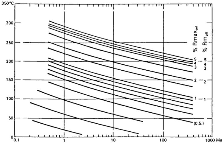
Abb. 5: Beziehung zwischen Vitrinitreflexion ( $R_m$ ,  $R_{max}$ ), maximaler Inkohlungstemperatur und effektiver Inkohlungszeit. Nach N. H. BOSTICK et al. (1979).
