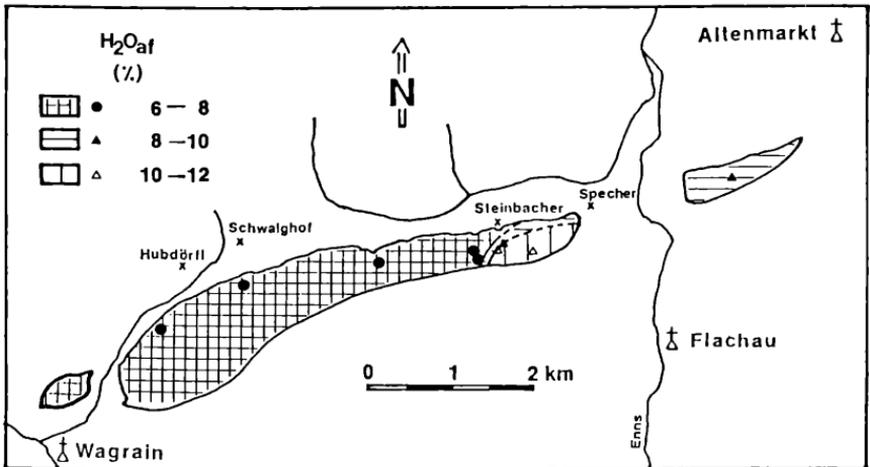
Abb. 3: Inkohlungskarte des Wagrainer Tertiärs (Basis: hygroskopische Feuchtigkeit).
