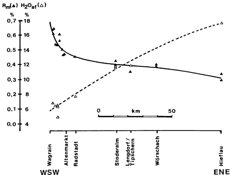
Abb. 4: Inkohlungsprofil durch die Liegendschichten des Ennstalertiärs.
