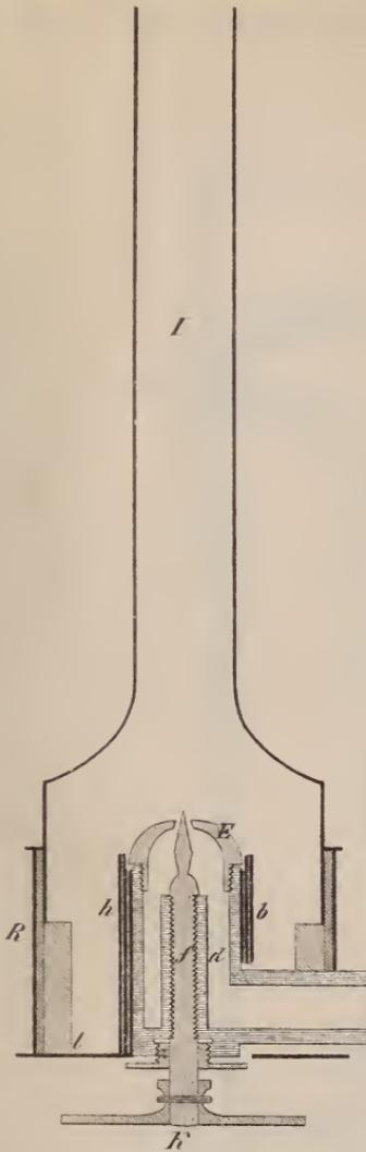
Durchschnitt des Verbrennungsapparates.
