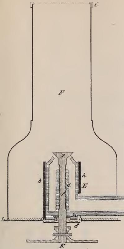
*Durchschnitt des Verbrennungsapparates.*
