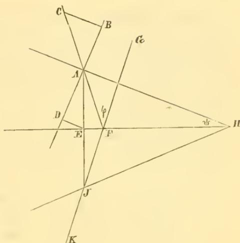
Abweichung  $\varphi$  nach der Formel  $\sin \varphi = n \sin \psi$  finden, wo  $\psi$  der halbe Winkel des brechenden Prismas ist und  $n$  der Brechungs-exponent.
