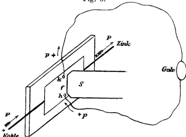
wirkung zu Stande gekommenen Stromes  $i$  die durch die Pfeile  $p$  bezeichnete, d. h. der Strom  $i$  fließt so, als ob die Goldplatte ein Element geworden wäre, wobei  $k$  den Kupferpol,  $h$  den Zinkpol und  $f$  die Flüssigkeit vorstellte. Dabei befindet sich der Südpol des Elektromagnets vor der Platte, der Nordpol hinter derselben.
