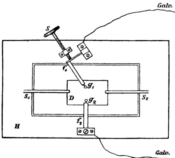
Breite, bei welcher die Stromzuleitung durch etwa 2 Mm. breite Stanniolstreifen  $s_1, s_2$  besorgt wurde, die über die Mitte der kurzen Seiten des Rechteckes geklebt waren.
