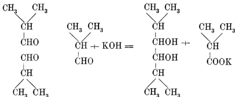
Bei der quantitativen Ausführung eines Versuches, zu dem ich 200 Grm. Isobutyraldehyd in Verwendung nahm, erhielt ich statt der berechneten 134 Grm. C<sub>8</sub>H<sub>18</sub>O<sub>2</sub> 129 Grm. dieses Körpers und statt der berechneten 81 Grm. Isobuttersäure 78 Grm.
