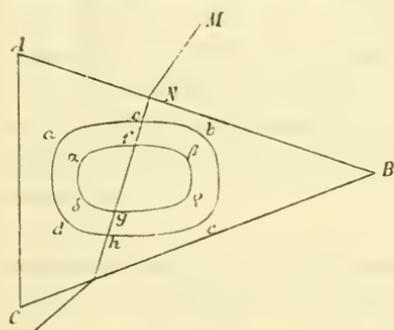
Dieser Hohlraum ist mit Luft gefüllt. Wenn nun der Strahl  $MN$  bei  $e$  in denselben eintritt und bei  $h$  ihn wieder verlässt, so ist er, meint Brewster, wegen des niederen Brechungsindex des Tabaschir so wenig gebrochen und so wenig reflectirt, dass das Stück durchsichtig erscheinen kann.
