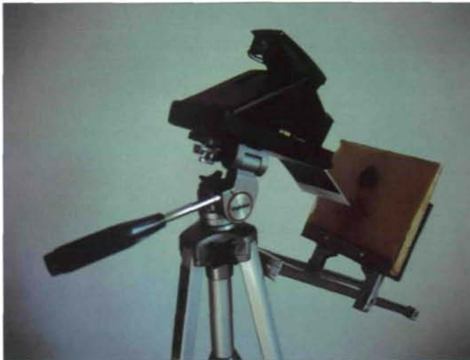
Abb. 5: Vorrichtung zum Abfotografieren der erfaßten Individuen. Foto: A. Pauli-Thonke
