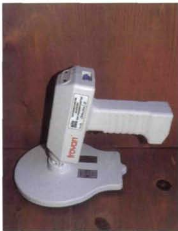
Abb. 7: Handlesegerät für passive integrierte Transponder. Foto: R. Jehle
