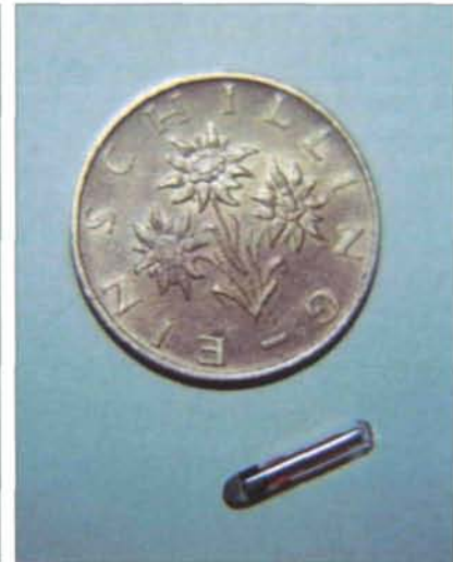
Abb. 6: Passiver Integrierter Transponder (aus JEHLE 1996). Foto: R. Jehle
