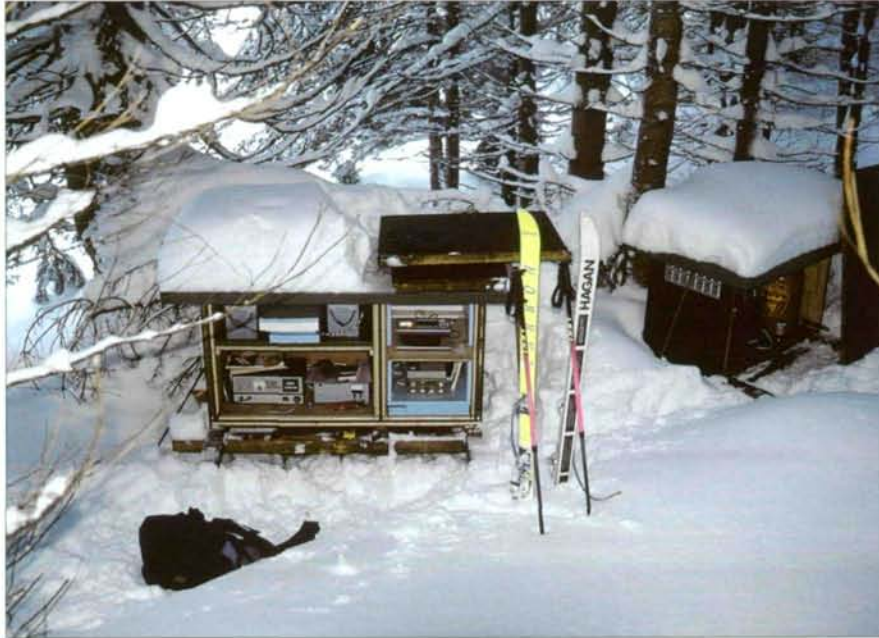
Abb. 4: Computergesteuerte Empfangs- und Aufzeichnungsanlage für telemetrisch übermittelte Körper- und Bautemperaturen im Freiland. Die Stromversorgung erfolgte über Batterien, die in etwa zweiwöchentlichen Abständen aufgeladen wurden.
