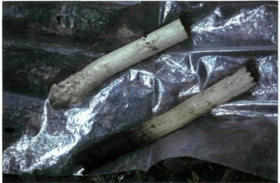
Abb. 12: Bohrkern vom Werzinger Moor: Übergang von Seekreide (weiß) zu Torf (schwarz), 10.7.1970
