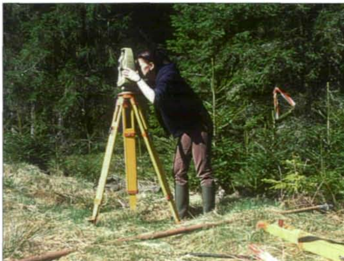
Abb. 3: Die tachymetrische Vermessung liefert genaue dreidimensionale Geländedaten zur Erstellung eines digitalen Höhenmodells (Foto: M. PÖSTINGER)
