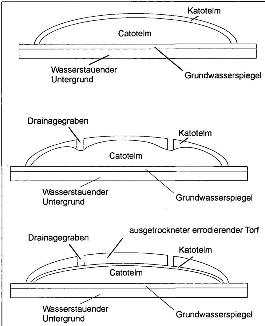
Abb. 9: Die Folgen der Entwässerung eines Hochmoores.
