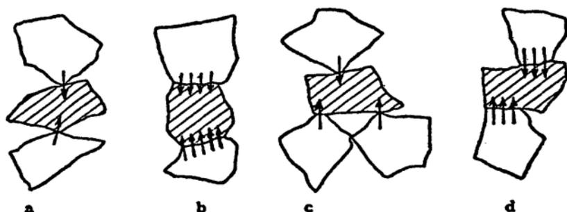
**Abbildung 3:** Schematische Veranschaulichung der Beanspruchung von Schotterstücken in der Straßendecke auf Zug (a), Druck (b), Biegezug (c) und Scherung (d).
