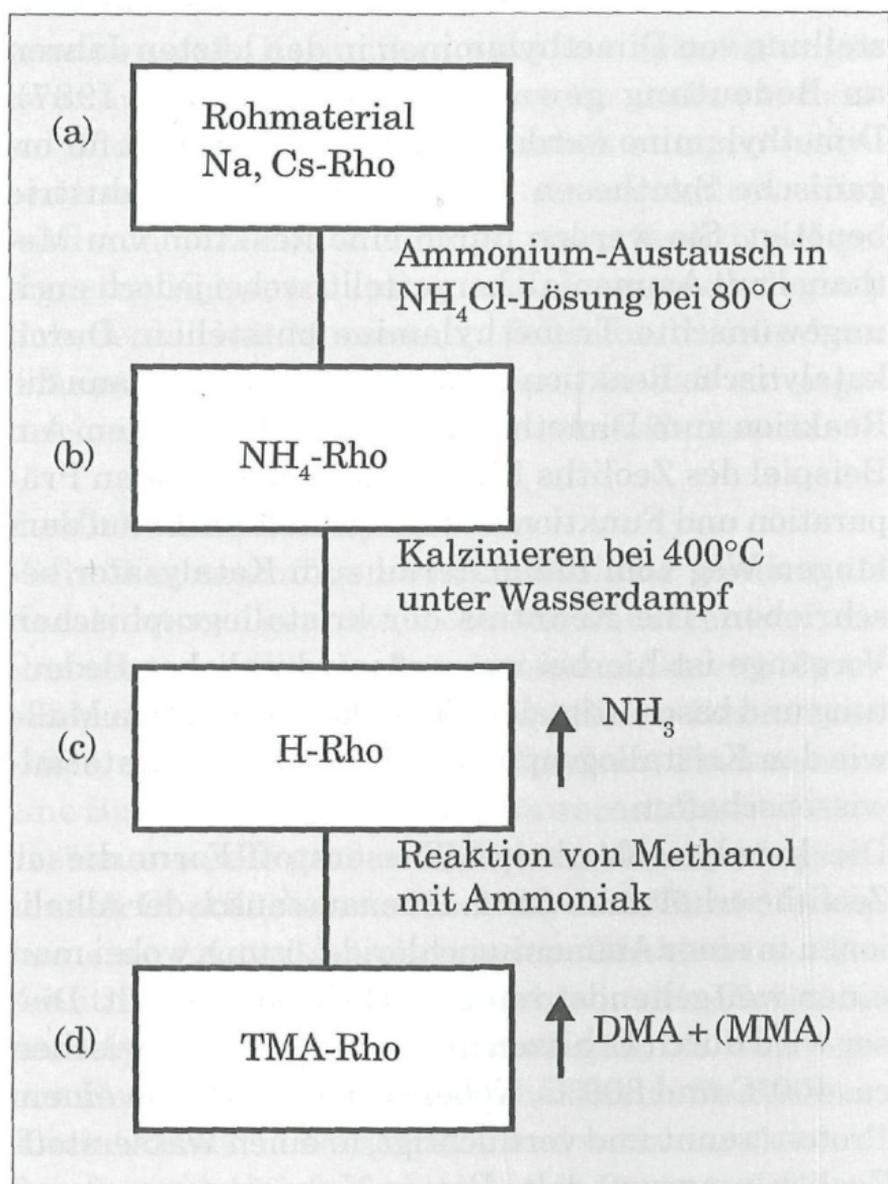
**Abb. 5:** Austauschprozesse zur Herstellung eines zeolithischen Katalysators.
