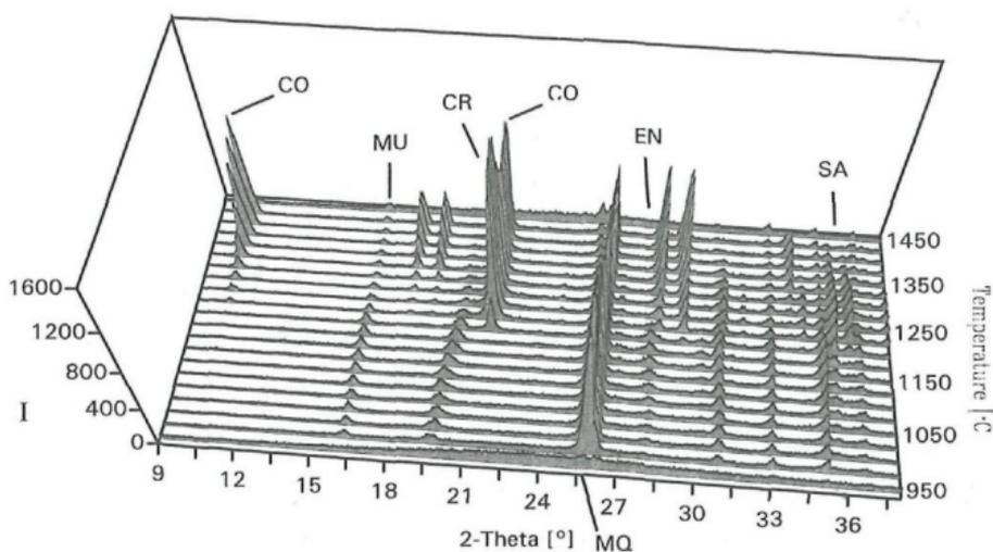
Abb. 4: *In situ* Beugungsexperimente mit einer Röntgenheizkammer (Fa. Paar, Graz). Der Kristallisationsprozeß von amorphisiertem Zeolith bei 950 °C bis zum Cordierit/Mullit bei 1450 °C ist in Schritten von 25 °C dargestellt. MQ: Mg- $\beta$ -Quarz, CO: Cordierit, MU: Mullit, CR: Cristobalit, EN: Enstatit, SA: Sapphirin.
