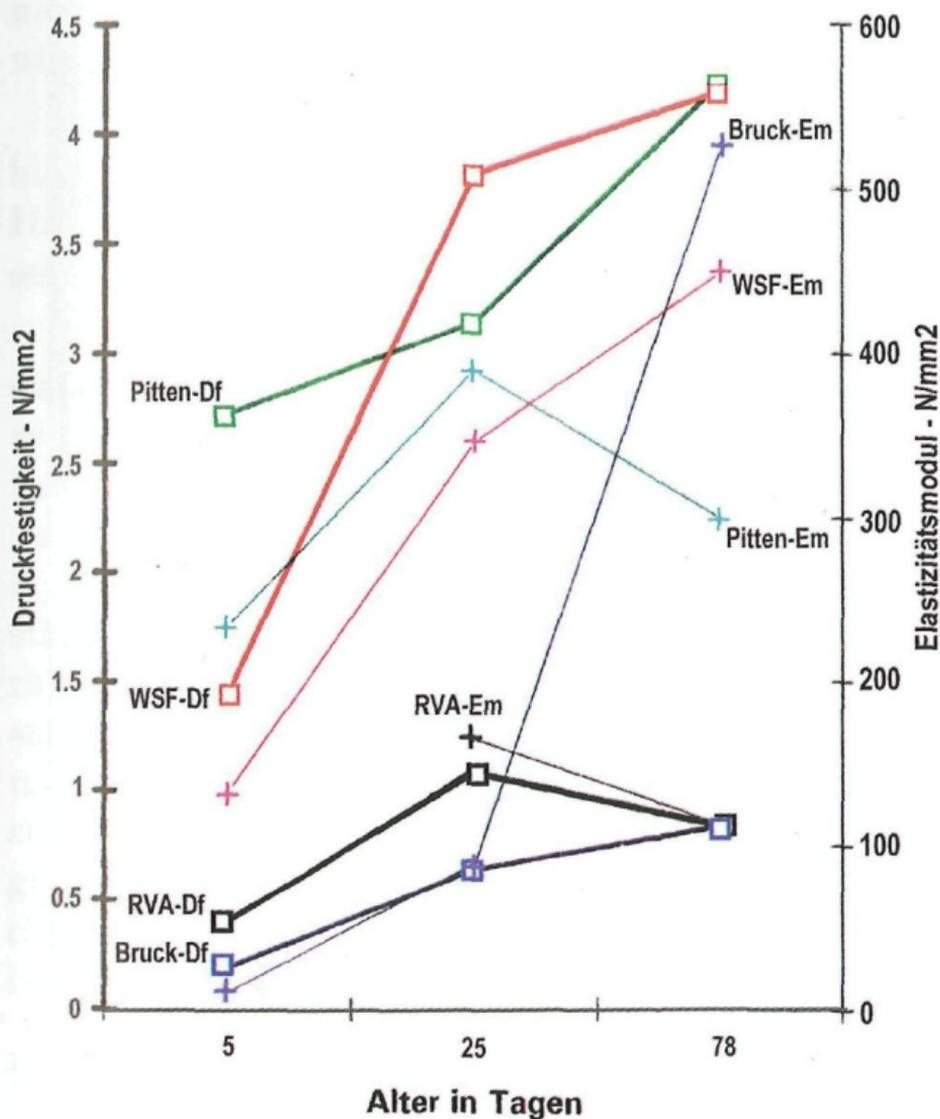
Abb. 5: Druckfestigkeiten und Elastizitätsmodule der Aschen
