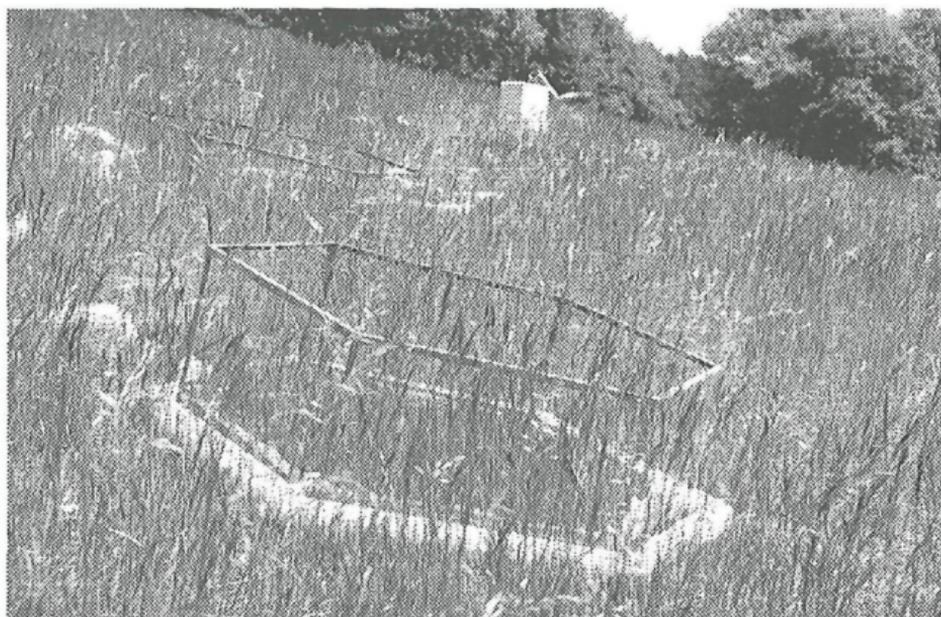
**Abb. 4:** Transparente Abgrenzungen halten eine "Wolke" von Luft mit erhöhtem  $\text{CO}_2$  in Ausschnitten natürlicher Bestände von Kalkmagerrasen im NW-Schweizer Jura. Eine Modellstudie über die Wirkungen von erhöhtem  $\text{CO}_2$ -Angebot auf die Biodiversität.
