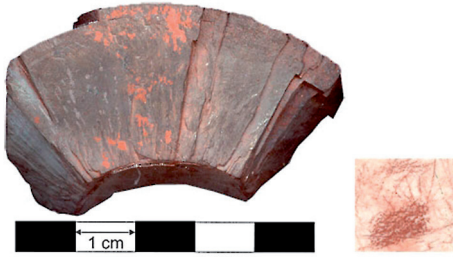
Abb. 3: Hämatit (Blutstein) mit Strichplatte (rotbrauner Strich), Cumberland, England. – Fig. 3: Hematite (bloodstone) with lineplate (reddish-brown line), Cumberland, England.
