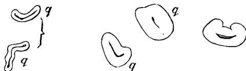
Querschnitte durch Baumwollfasern. Vergr. 325 fach.
