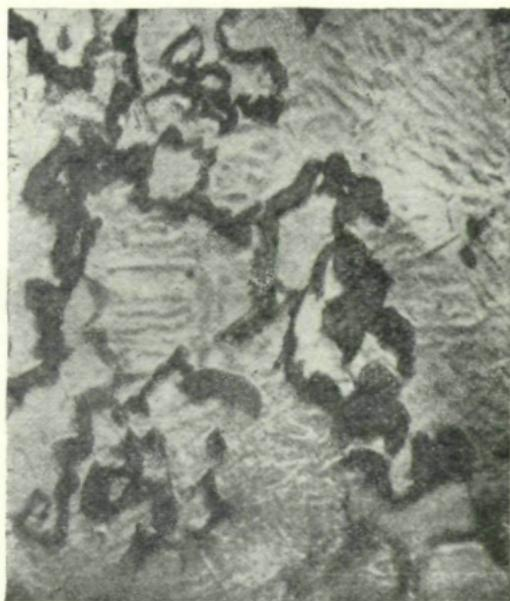
Fig. 12. Troostit (Osmond) in 610facher Vergrößerung. Eisen mit 0,45% Kohlenstoff, auf 825°C erhitzt, bis 690°C langsam abgekühlt und dann in Wasser von Zimmertemperatur abgeschreckt. Harte Kerne aus Martensit und weiche Fetzen aus Ferrit.
