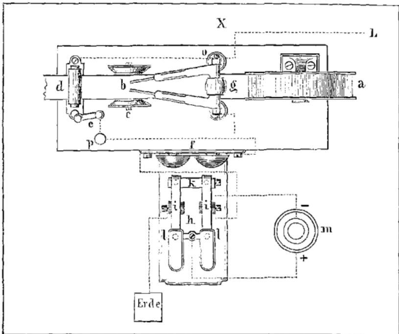
lässt die Haupttheile und die Drahtverbindung erkennen; *a, a'* bedeutet die Papierwalze, von welcher der chemisch präparirte Papierstreifen über eine Anzevvorrichtung zwischen dem Doppeltifte *b, b'* und der Leitwalze *c, c'* mittelst des metallenen Triebwerks
