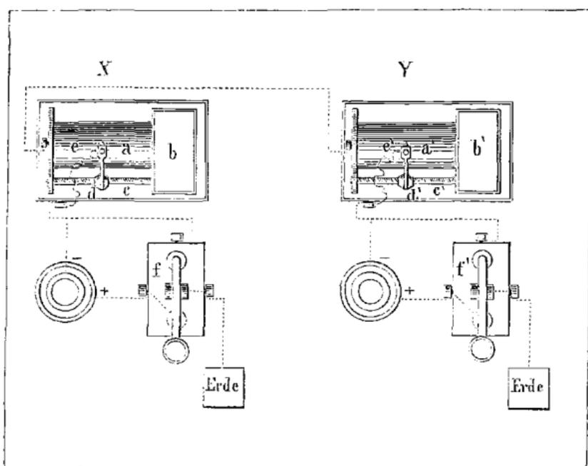
befindet sich (s. Fig. 4) eine Metallwalze ( $a, a'$ ), welche durch ein Uhrwerk ( $b, b'$ ) in eine gleichmässig rotierende Bewegung versetzt werden kann. Durch zweckmässig in einander eingreifende, gezähnte Räder wird eine parallel zur Axe der Walze angebrachte Spindel ( $c, c'$ ), an deren Oberfläche äusserst genau und sehr enge Schraubengänge eingeschnitten sind, um ihre Län-
