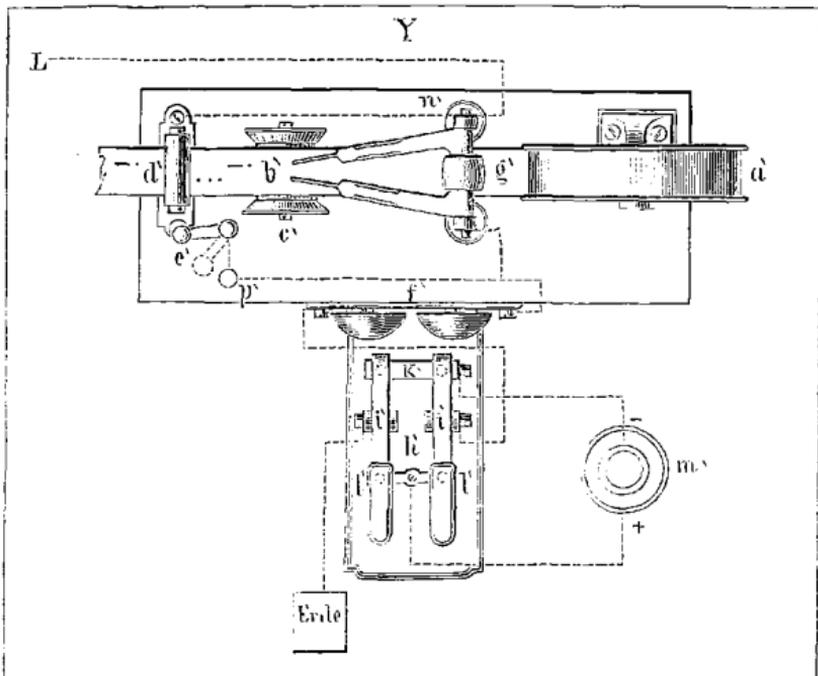
Metallhebeln dargestellt, welche um die Axen  $i, i'$  drehbar sind, in der Ruhelage mit ihren hinteren Enden auf dem Metallstreifen  $k, k'$  aufruhren, beim Niederdrücken jedoch von dieser abgehoben, dagegen mit der Metallfeder  $l, l'$  in Berührung gebracht werden.
