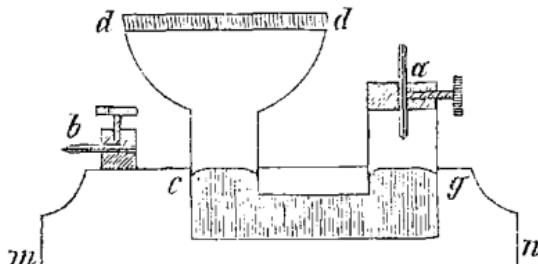
Grösse. Er besteht aus einer kreisförmigen Fussplatte *mn* aus Gusseisen, die bis auf eine communizirende Röhre *eg* massiv ist; an dem einen Ende ist diese Röhre mittelst eines eisernen Trichters abgeschlossen, in dessen weitere Mündung das poröse Diaphragma *dd* eingekittet ist; das andere Ende der Röhre mündet bei *g* in eine Glasröhre, welche bei *b* eine Messingkappe trägt, in der ein nach unten verplatinirter Kupferdraht mittelst einer Klemmschraube
