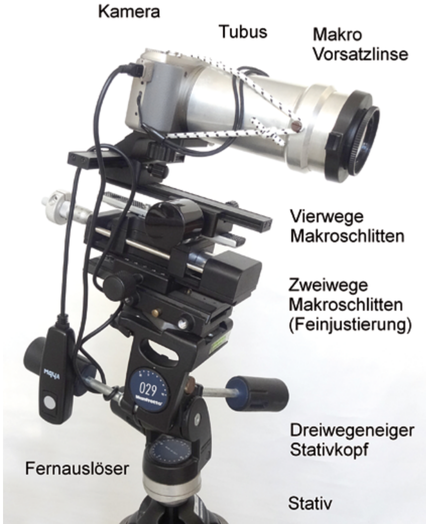
Abb. 1: Für Studioaufnahmen bewährter Aufbau.
