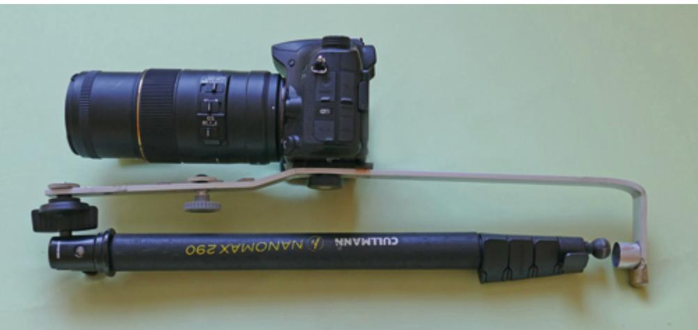
**Abb. 2:** Schulterstütze mit Einbeinstativ für eine Kamera.
