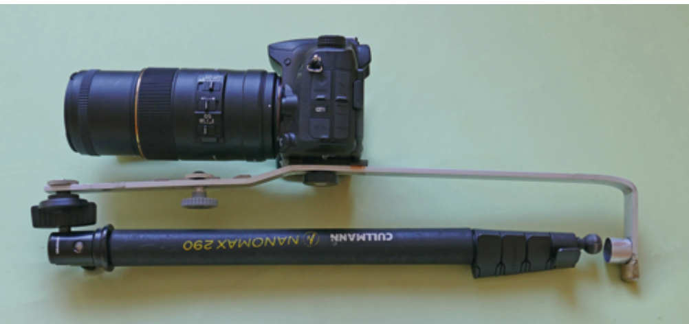
Abb. 2: Schulterstütze mit Einbeinstativ für eine Kamera.
