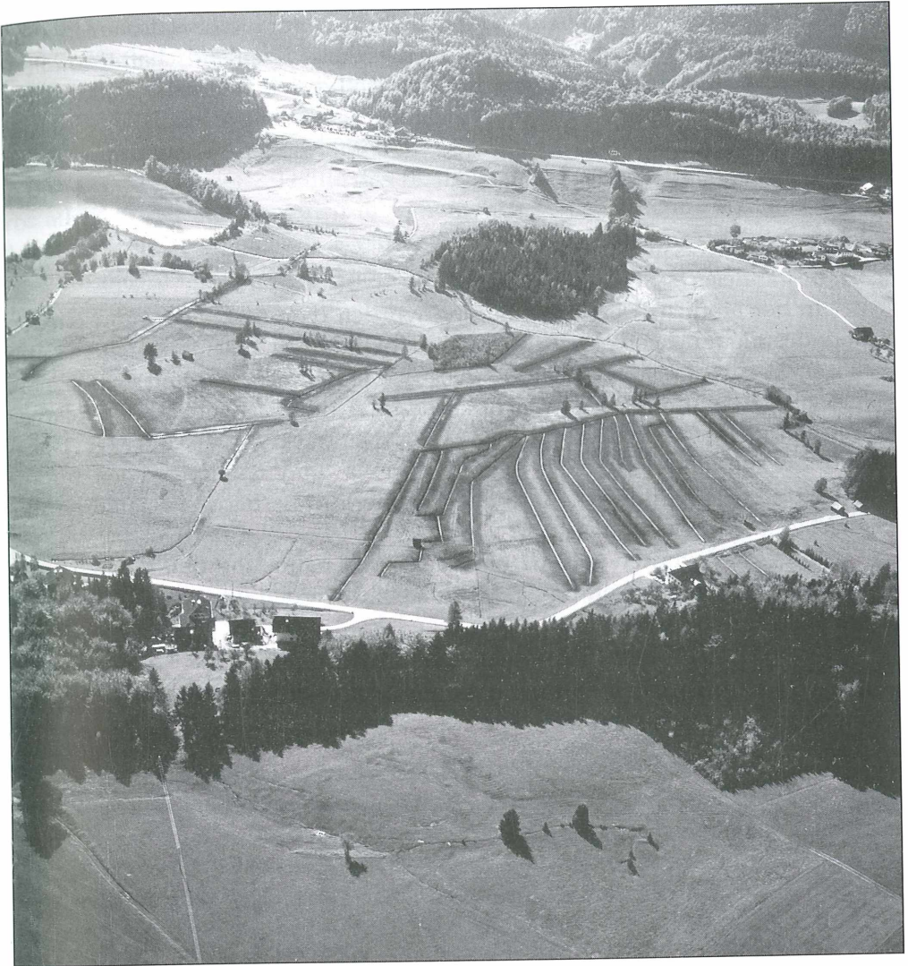
Abb. 2: Blick vom Norden auf das Fuschlseemoor (Orig., Amt der Salzburger Landesregierung, Naturschutzreferat, Oktober 1982). Im Zentralteil des NSG Fuschlsees wurden im Herbst 1982 die Gräben nachgezogen, im eigentlichen Planungsgebiet dagegen nicht. Hinter dem mit einigen Gehölzen bestockten Badeplatz sieht man auf einer völlig gehölzfreien Streuwiese noch ein größeres dystrophes Gewässer. Es haben sich davon keinerlei Reste erhalten, hier stockt jetzt ein dichter Kiefern-Birken-Moorrandwald (Biotop 59). Im oberen Bildteil gut erkennbar sind schließlich noch die bewirtschafteten und zur Gänze gehölzfreien Magerwiesen um den heutigen Jagdhof zwischen dem Golfplatz und der Wolfgangsee-Bundesstraße.
