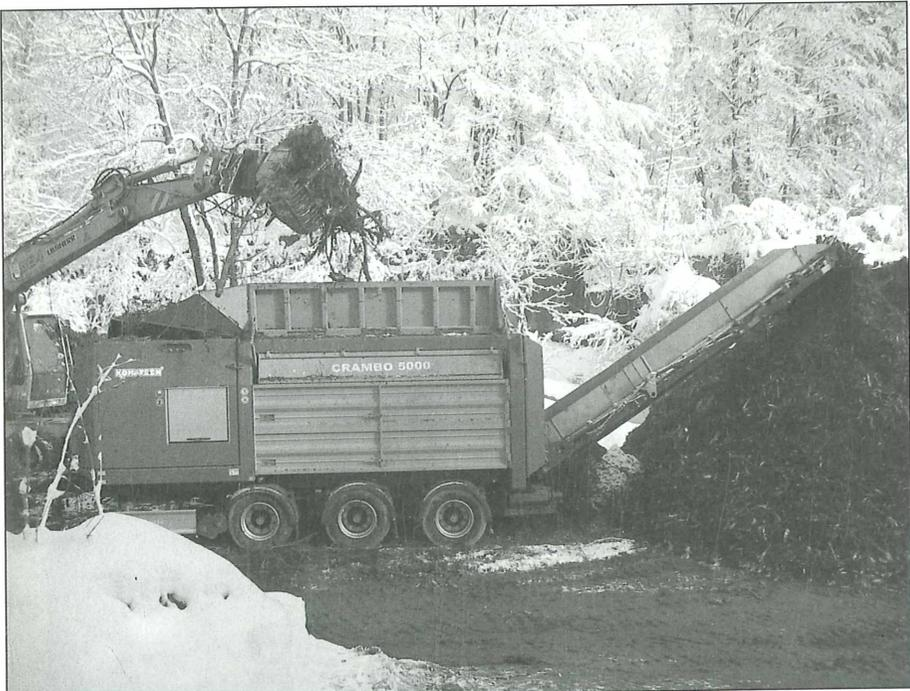
Abb. 14: Laufende Erzeugung von Häckselgut, das anschließend an diverse Heizkraftwerke geliefert wurde (15.11.2007; Foto: Ch. EICHBERGER).
