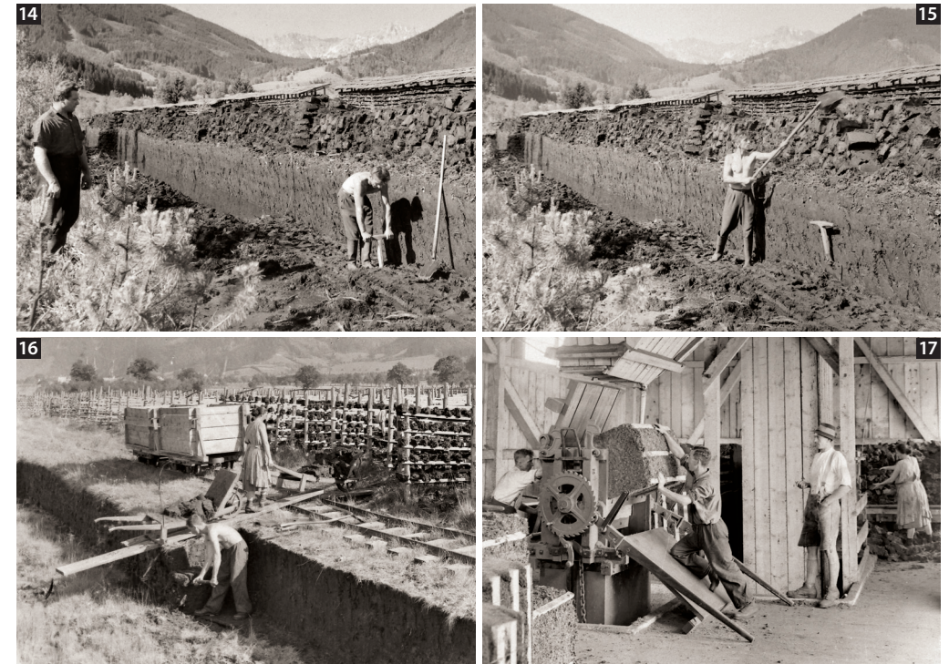
Abb. 14/15/16/17 | Handarbeit im Frauenberger Moor mit Grabschbeit (14), Wurfschaufel (15) und Scheibtruhe (16); Torfballenpresse (17) | Fotos: Fankhauser (1967)
