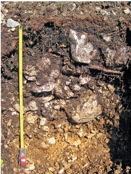
Abb. 1 | Bodenprofil Brettfläche oben: Bodentyp Moder-Rendzina | Foto: Th. Zimmermann
