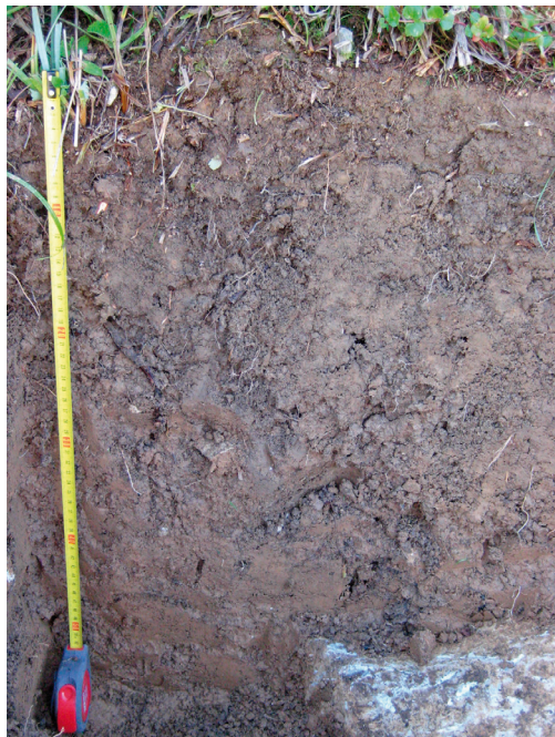
Abb. 2 | Bodenprofil Hochkarfläche unten: Bodentyp Kalkbraunlehm | Foto: Th. Zimmermann
