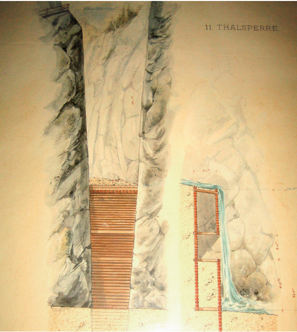
Abb. 3 | Talsperre 11: Die „Gallerie“ liegt hier 29 m über dem Schluchtgrund | Fotos: J. Hasitschka
