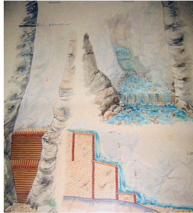
Abb. 4 | Talsperre 9: Die Schlachten sind stufenweise angeordnet, die Längshölzer mit langen Schlachtennägeln auf den Querhölzern befestigt (siehe Seitenansicht)
