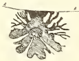
Abb. 2. Rosettenförmige Sonnenflinte mit teilweise lappigen Blättern und neuen Sprüngen, die von diesen ausgehen. Vergr. 10:1.
