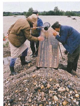
Na primernem prodišču so postavili topolovo desko in ločili drobnozrnati in težji material od debeložrnatega in lažjega. Foto: Milan Bidovec
