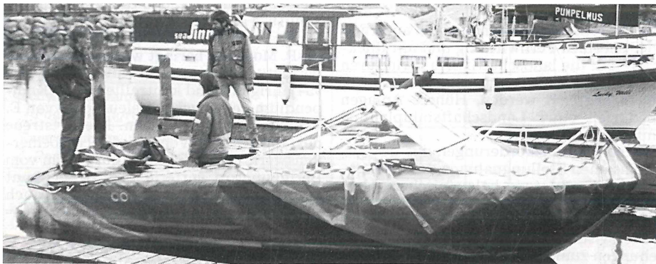
Das Boot des Vereins Jordsand nach dem Anlegen der Unterwasserplane. Foto: B. Watermann
