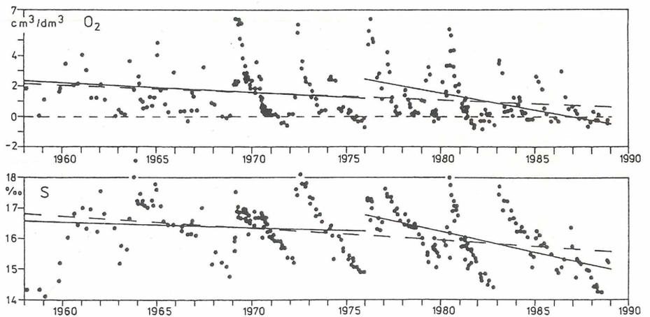
Abb. 7: Lebensbedingungen im Bodenwasser des Bornholmtiefs 1958 bis 1989. Oben: Sauerstoffkonzentration ( $\text{cm}^3/\text{dm}^3 = \text{Milliliter pro Liter}$ ) und Schwefelwasserstoff-Konzentrationen (werden als negative Sauerstoff-Äquivalente dargestellt). Unten: Salzgehalt (aus NEHRING & MATTHÄUS 1991).
