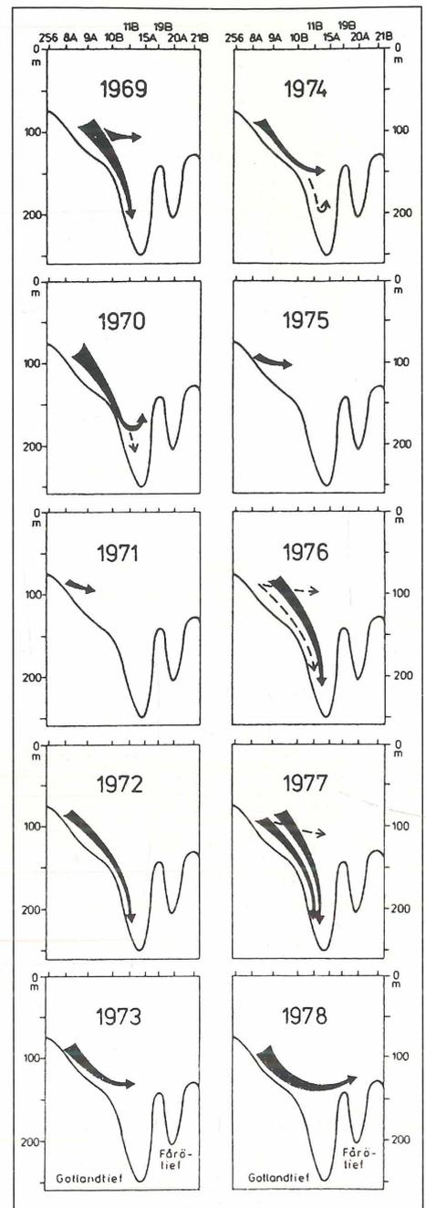
Abb. 5: Schematische Darstellung des Einstroms von salzreichem Wasser entweder in die bodennahe Wasserschicht oder in die Zwischenwasserschicht (in etwa 100 Meter Wassertiefe) in der Östlichen Gotlantsee. Dargestellt werden die Verhältnisse bei Salzwassereintrüchen in den Jahren 1969 bis 1978 (aus NEHRING & FRANCKE 1981).
