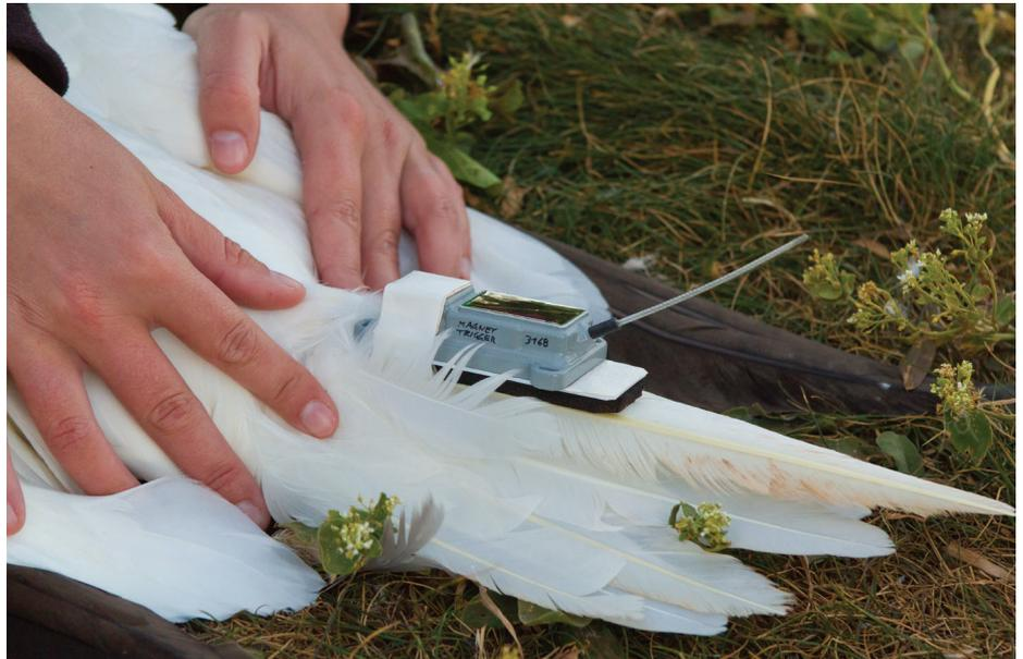
Mit Gewebe-Klebeband wird der Dattenlogger auf die Schwanzfedern des Basstölpels geklebt. Spätestens bei der nächsten Mauser wird er abfallen. Foto: Sebastian Conradt
