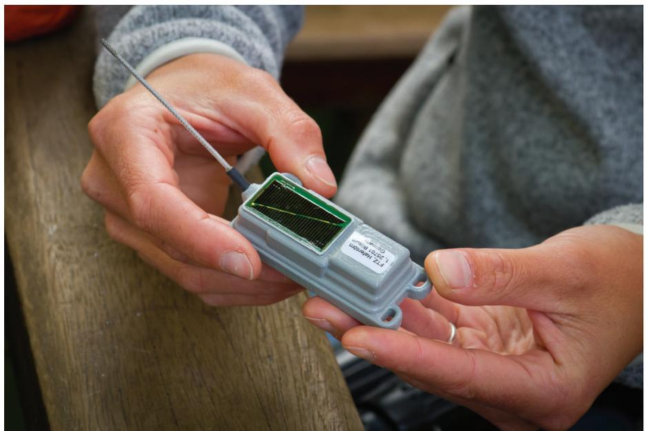
Die Datenlogger verfügen über ein Solarpanel, das sie mit Energie versorgt. Über die Antenne können die Daten ausgelesen werden, ohne dass der Vogel dafür wieder gefangen werden müsste. Foto: Sebastian Conradt
