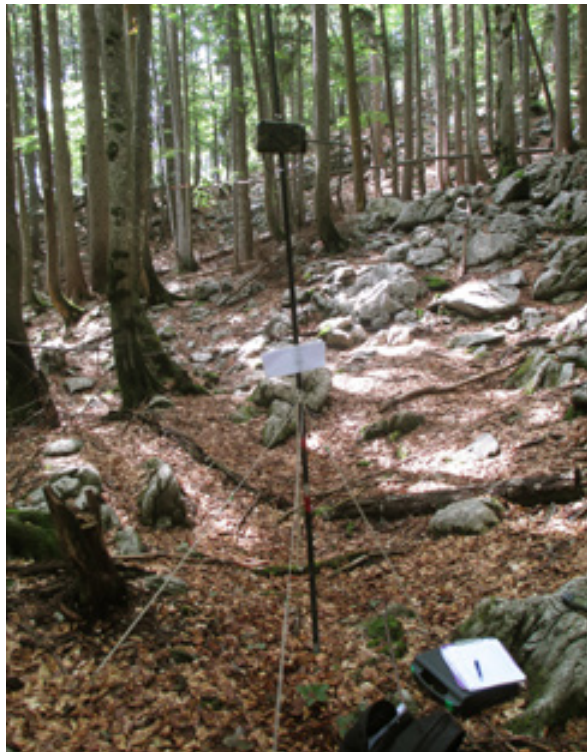
Abb. 1: Batcorder zur automatischen Aufzeichnung von Fledermausrufen an einem Standort im Rothwald. (©Teresa Knoll)
